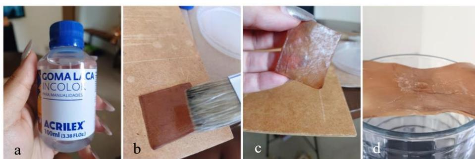
Figura 30 – Da esquerda para a direita: a) Goma laca incolor da marca Acrilex; b) Aplicação da goma laca incolor na celulose; c) Brilho após a aplicação da resina; d) Teste de absorção de água após aplicação da resina. Fonte: Autora (2024).
