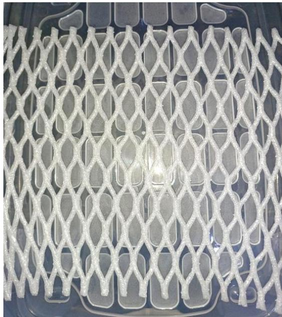
Figura 13 – Rede de proteção de garrafas de vidro sob tampa de plástico para secagem da amostra.
