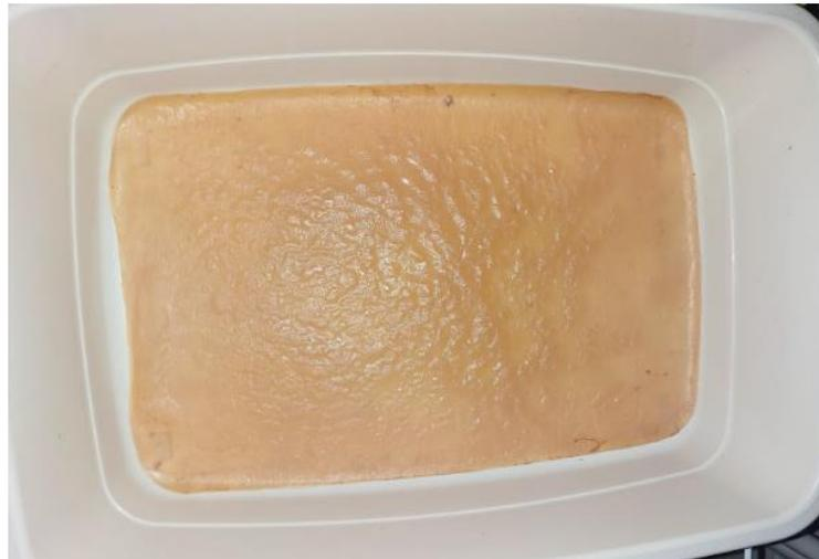
Figura 12 – Celulose bacteriana secando sob superfície lisa de plástico polipropileno.
