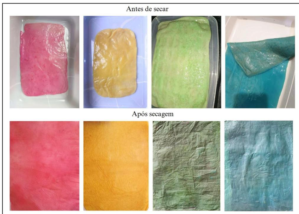
Figura 22 – Celulose bacteriana tingida em diferentes cores por submersão 48 horas.
