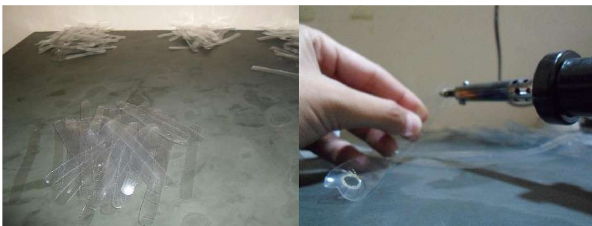
Figura 46 – Tiras de garrafas PET cortadas e furadas com ferro de solda
