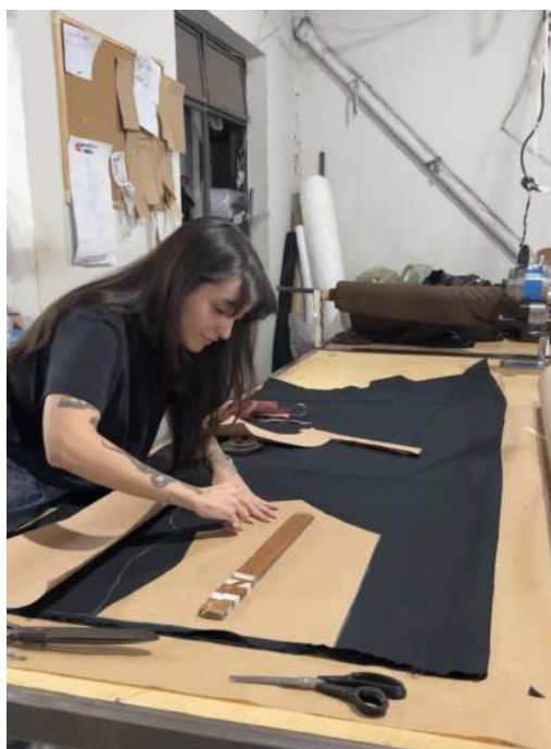
Figura 9 - Foto do processo de risco do mapa de corte
