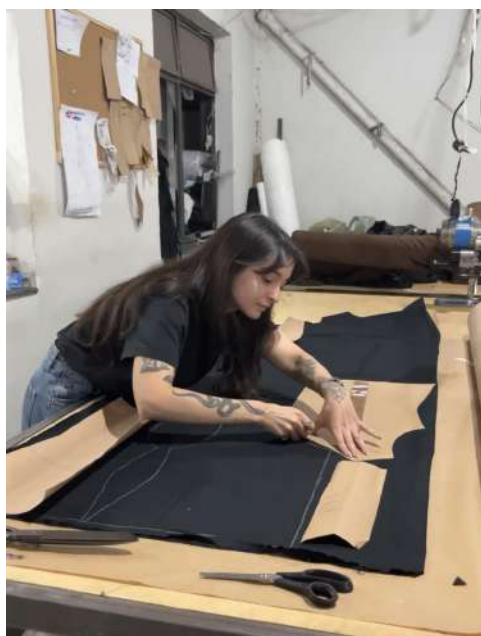
Figura 11 - Foto do processo de risco do mapa do colete
