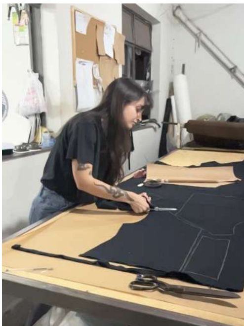
Figura 7 - Foto do processo de corte do colete
